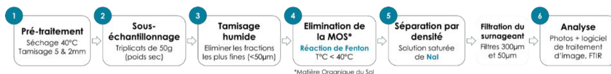
Figure 2 : Principales étapes du protocole d'extraction de microplastiques appliqué sur les échantillons de sol du projet MICROSO. Tailles des particules étudiées : {315 µm ; 5 mm}.
